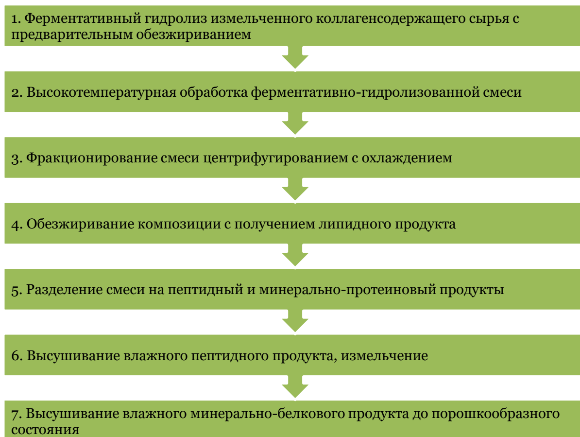
Рисунок 8 – Комплексная безотходная и экологически безопасная схема переработки рыбных отходов
