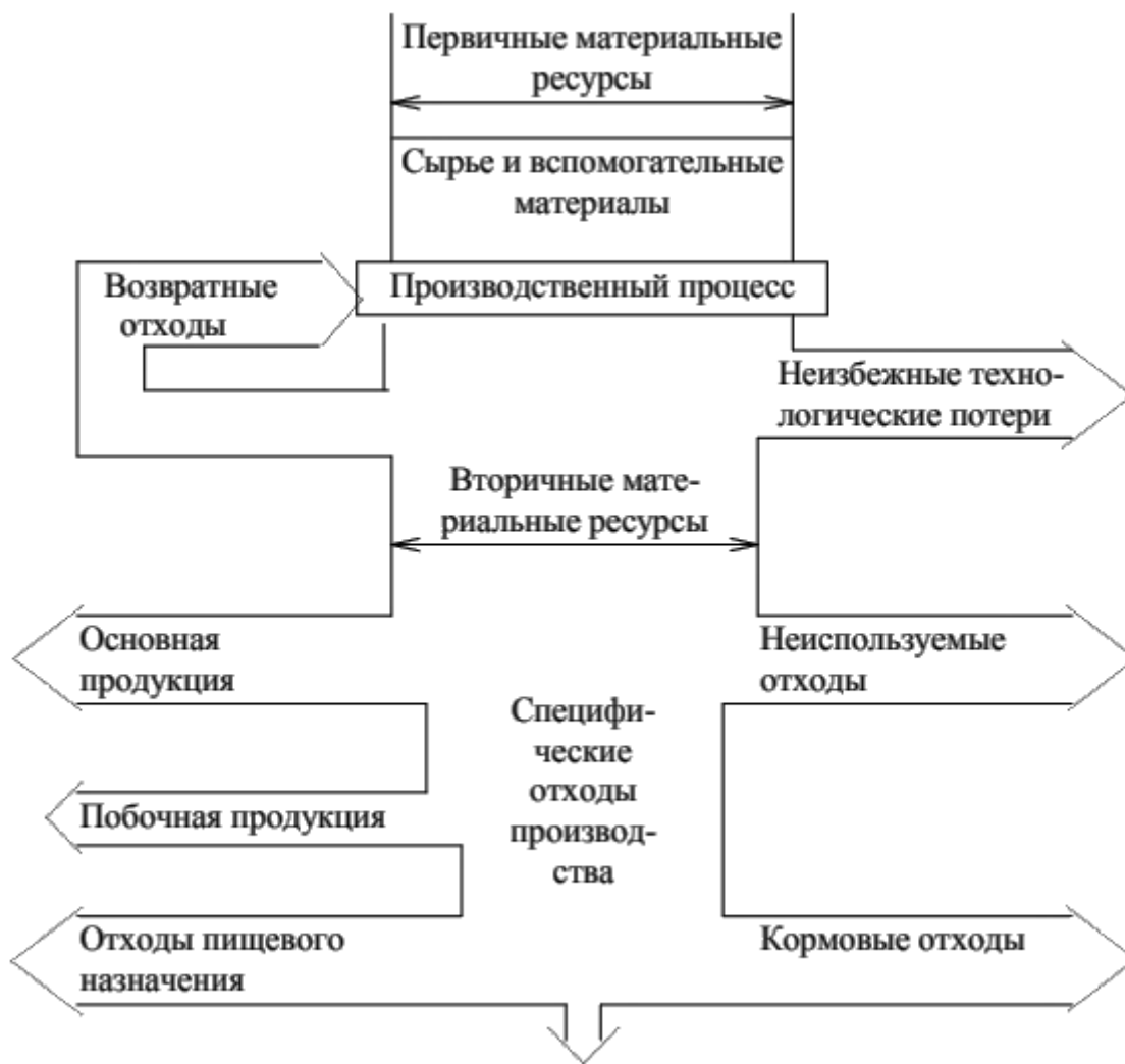
Рисунок 6 – Схема образования вторичных отходов производства
